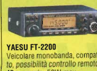
YAESU FT-2200 Veicolare monobanda, compa- tto, possibilità controllo remoto, 49 memorie, 50W max
