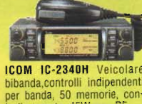
ICOM IC-2340H Veicolare bibanda, controlli indipendenti per banda, 50 memorie, contro- llo remoto, 45W max RF
